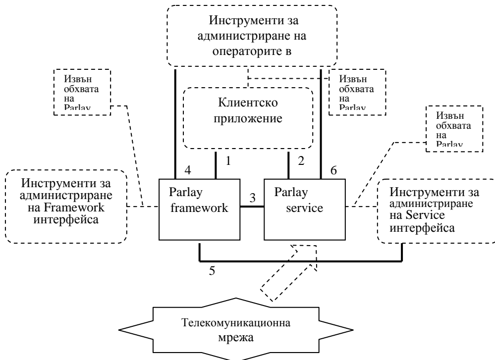
Фиг:4 Схема на Parlay API интерфейсите
