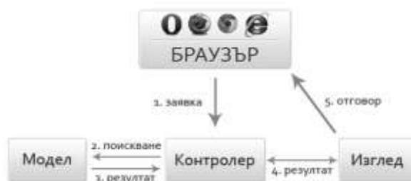
Фигура 6. Движение на заявка от потребител при архитектурния шаблон MVC
